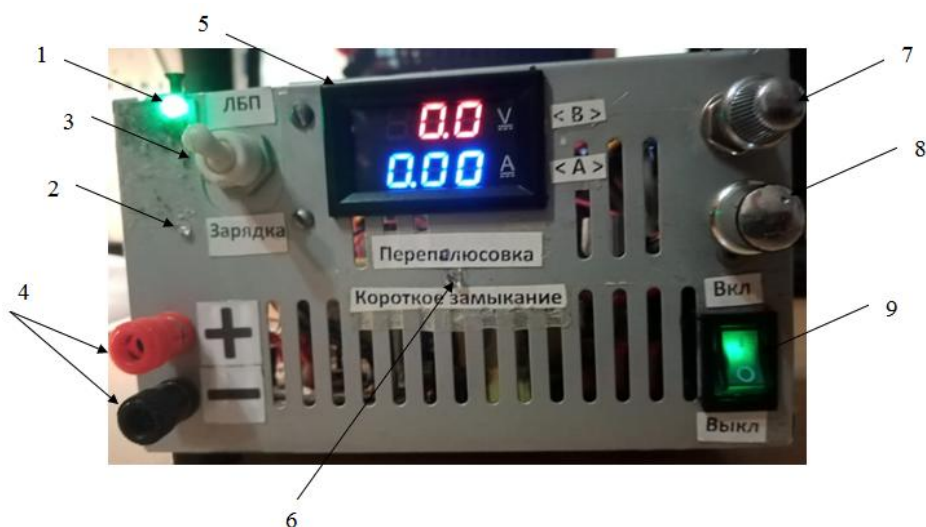
Рисунок 5 – Модернизированный компьютерный импульсный блок питания (передняя панель): органы управления.
