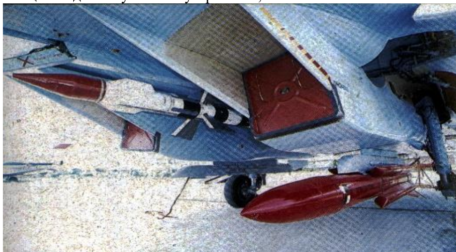
Рисунок 1 – Изображено размещение группы однотипных катапультиных устройств на самолете
