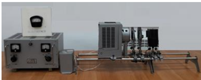
Сурет 2 – ФОС-67 оптикалық орындығы бар әмбебап проекциялық аппарат
