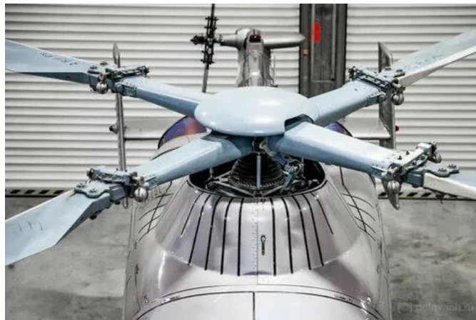
Рисунок 2. Конструкция безвтулочных вертолётных несущих винтов
