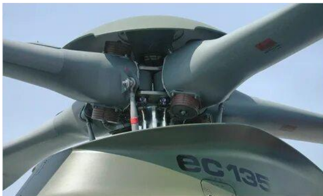
Рисунок 1. Безвтулочный вертолётный несущий винт вертолёта EC136
