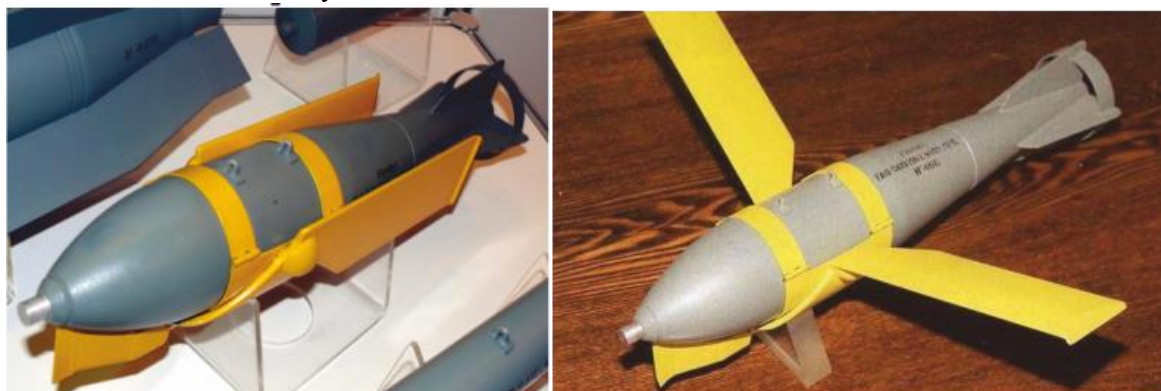
Рисунок 11. Бомба Фаб-500 С УМКП: крыло в убранном положении (слева) и в выпущенном (справа)
