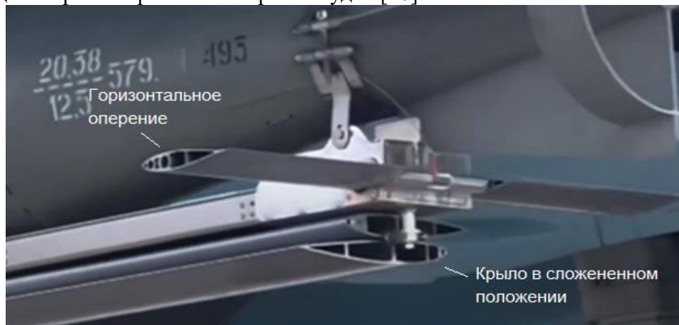
Рисунок 9. Крыло и горизонтальное оперение бомбы ФАБ-500
