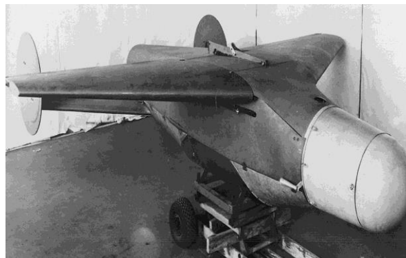
Рисунок 4. Самонаводящаяся противокорабельная авиационная бомба ASM-N-2 Bat
