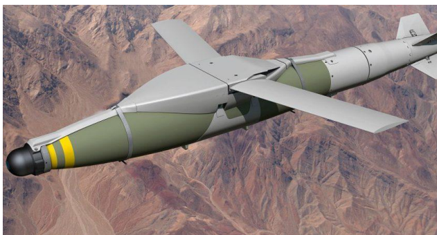
Рисунок 5. Американская УПАБ семейства Joint Direct Attack Munition
