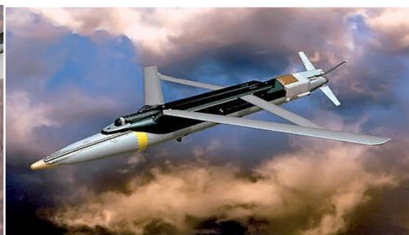
Рисунок 6. Американская УПАБ АБ GBU 39 с ромбовидным крылом
