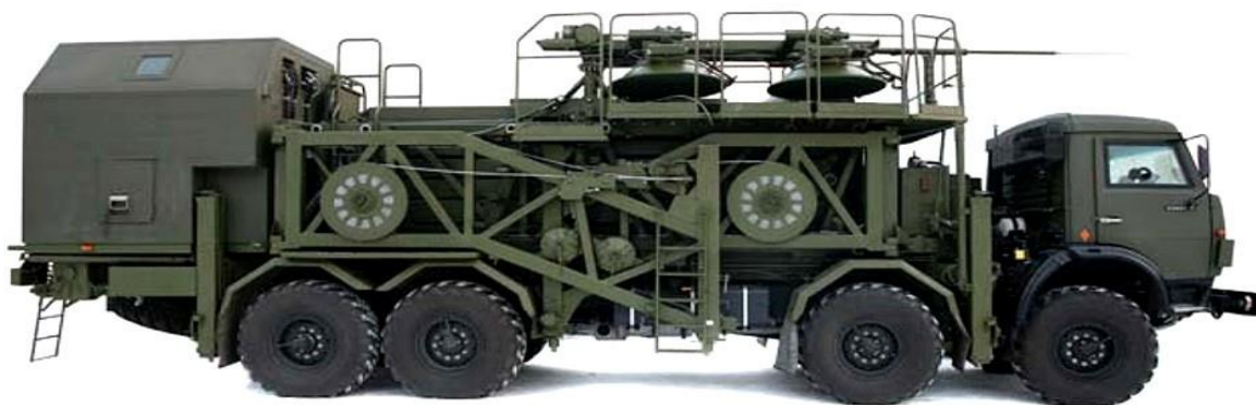
Сурет 2. Ресейлік «Краснуха-4» кешені Zapad-2017 және United Trident-2018 жаттығулары кезінде GPS сигналдарына кедергі келтірді.
