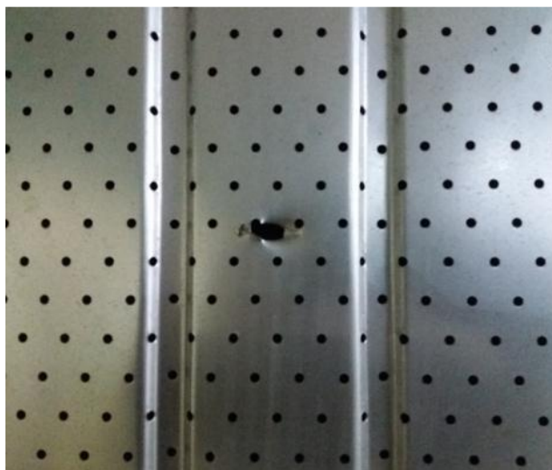
Рисунок 6. – Пробитие перфорированного листа.
