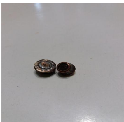
Рисунок 2. – Полная деформация пуль.
