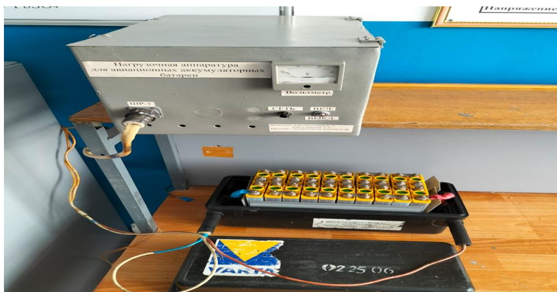
Рисунок 5 - Подключение установки к авиационной аккумуляторной батарее
