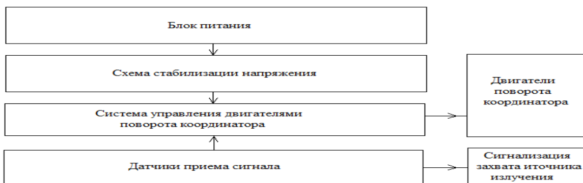
Рисунок 1 - Функциональная схема основных элементов стенда пассивной головки самонаведения.
