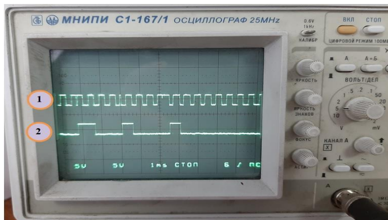
Рисунок 5 - Изображение осциллограмм входного и выходного сигналов устройства детектирования
